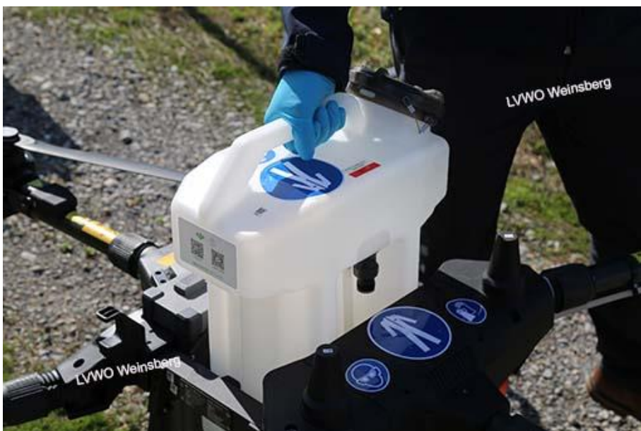
Abbildung 6: DJI Agras T16 Tank einsetzen
