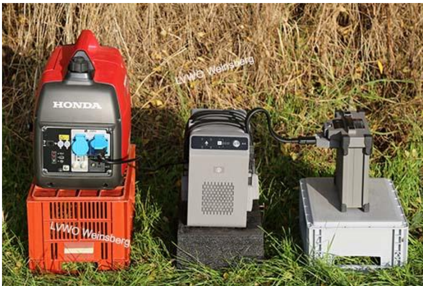
Abbildung 7: Ladung der Akkus mittels Generator neben der Rebfläche
