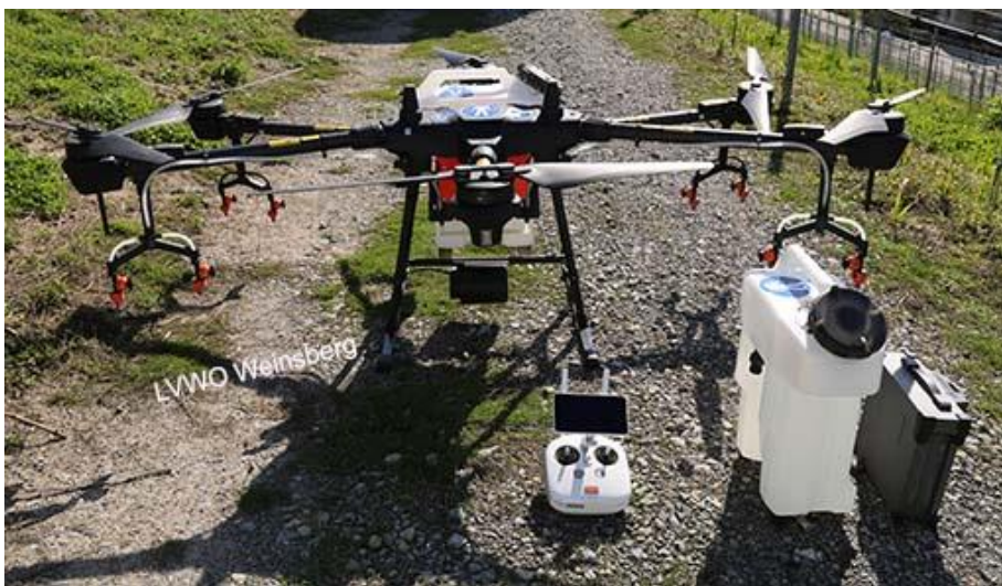
Abbildung 5: DJI Agras T16 ausgefaltet, Tank und Akku eingesetzt
